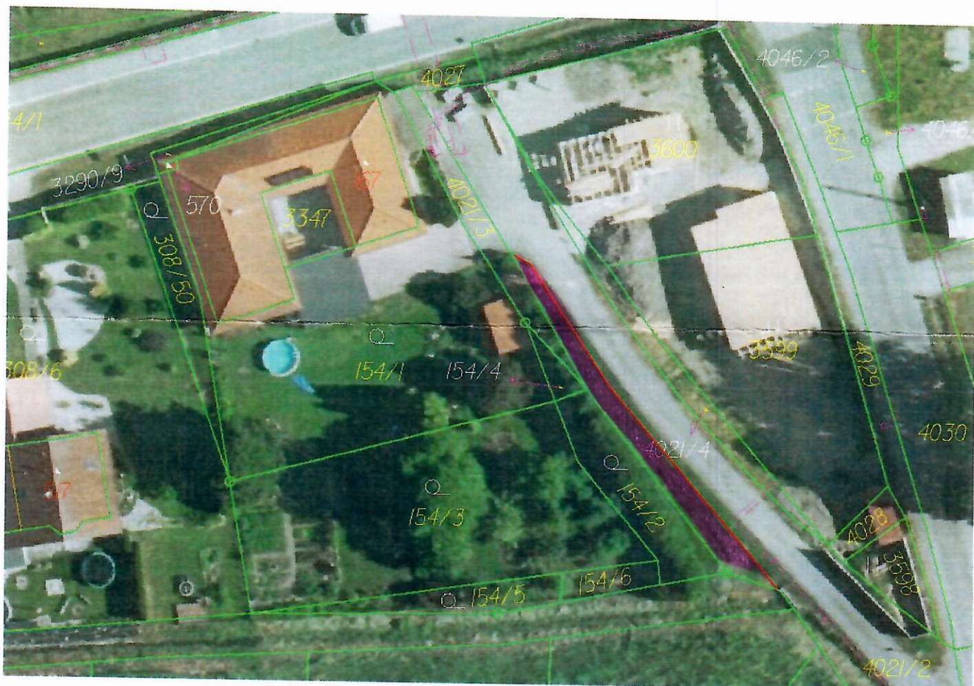
Soutisk katastrální mapy s ortofotem s vyznačeným návrhem nově oddělované části pozemku č. 4021/2
